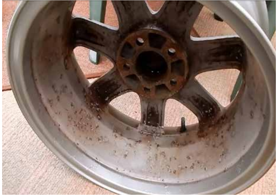
Tuz Korozyonuna Uğramış Jant
